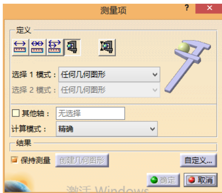
图 13: 测量实际翼型的每个截面的面积
